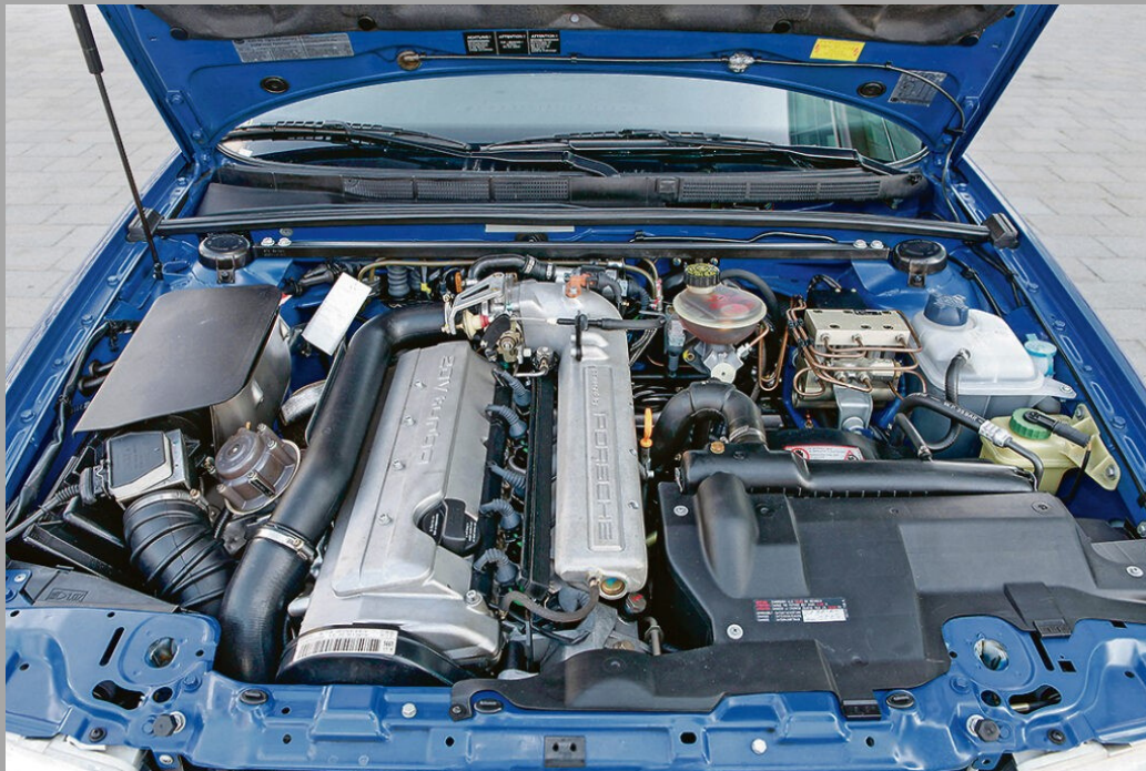
moteur Quattro, 310 cv, 5 cylindres, 2.2 l, 20 soupapes
